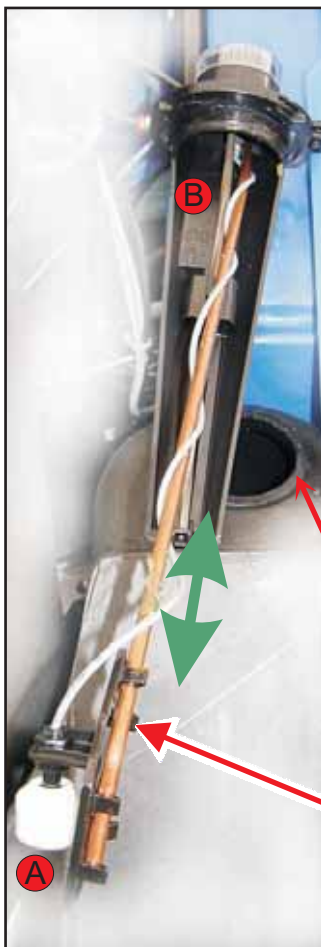
Abb. 6.28: Tankanzeige &amp; Schwimmerschalter
