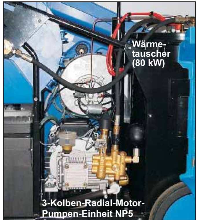
Abb.3.2: Neptune 5 (Motor-Pumpen-Einheit NP5 & Wärmetauscher)
