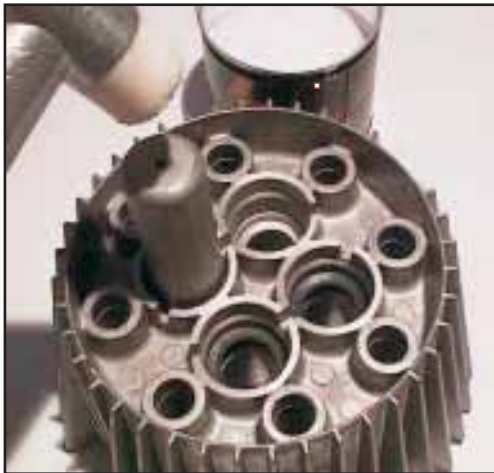
Abb. 6.6: Einbau der Ölmanschetten
