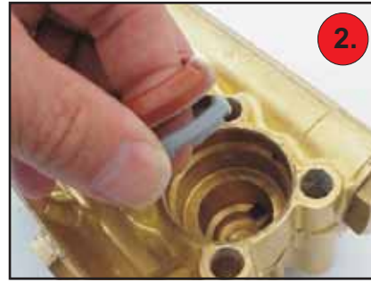
Abb. 6.16: Einbau der Hochdruckmanschette &amp; Distanzstück
