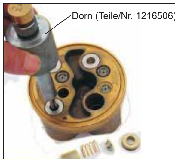
Abb. 6.2: Ausbau der Einlassventile
