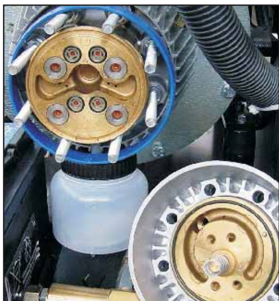
Abb. 6.1: Pumpe C3 mit ausgebautem Zylinderkopf
