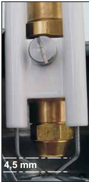
Abb. 6.26: Elektroden &amp; Brennstoffdüse
