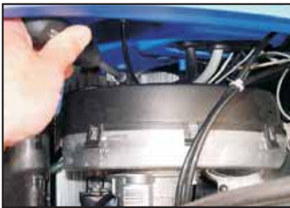
Abb. 7.5: Einstellung der Luftklappe
