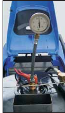
Abb. 7.3: Messen des Brennstoffdrucks
