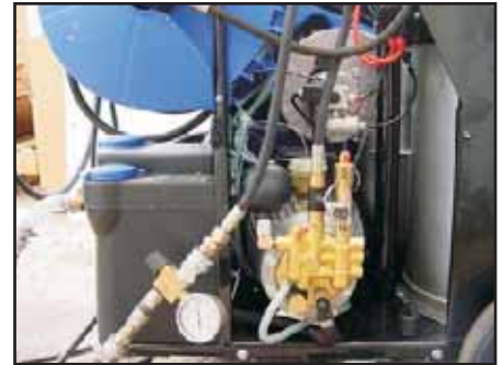
Abb. 7.2: RSB mit Testmanometer
