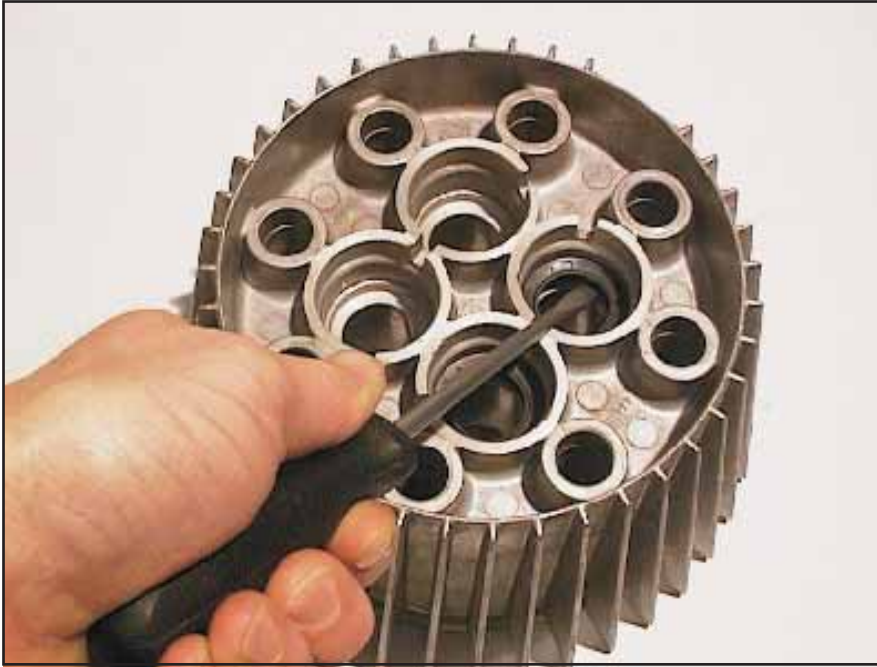
Abb. 6.5: Ausbau der Ölmanschetten
