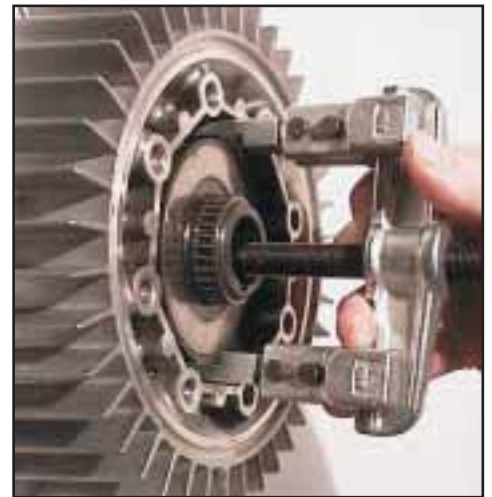
Abb. 6.7: Ausbau der Taumelscheibe
